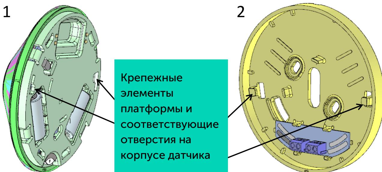
При монтаже сначала устанавливается платформа, к ней подводятся все необходимые провода, если нужно. После этого необходимо совместить крепежные отверстия на корпусе датчика и крепежные элементы на платформе и повернуть датчик по часовой стрелке до уверенного щелчка.
